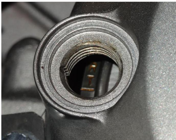
Пред сборкой необходимо смазать поверхности трения распредвала и постели, резьбу болтов постели моторным маслом. Постель усаживать плавно, вручную, ни в коем случае не применяя молоток. Постель распредвала садится туго, по направляющим. Удары могут перекосить ее и замять направляющие, а так же повредить рабочие поверхности.
