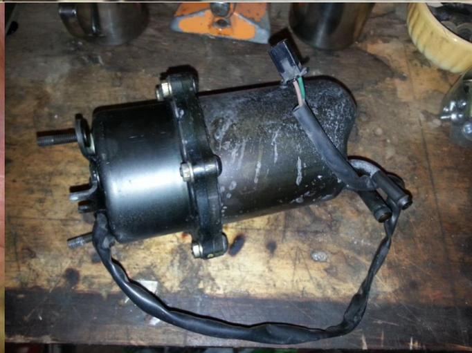
Инспектирование бензиновых фильтров в бензобаке, снимаем вентили, чистим.
