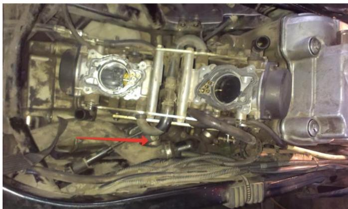
Перед откручиванием натяжителей необходимо снять клапанные крышки для [проверки меток](#), операцию лучше совместить с регулировкой клапанов.
