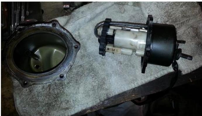
Отсоедините разъем насоса и вытащите уплотнительную резиновую шайбу.
