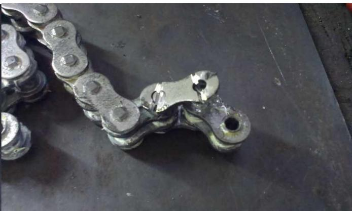
Разворачиваем цепь на столе, собираем замок, не забывая про резинки, смазать оси замка цепи (смазка белого цвета идёт в комплекте с замком). Берём штанген-циркуль и мерим расстояние между звеньями, запоминаем!
