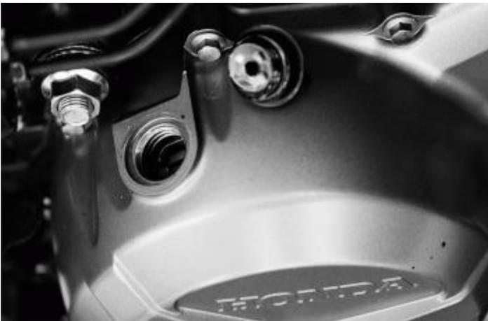
Открутите маслоливной болт в заднем нижнем краю с левой стороны двигателя и дайте маслу стечь в емкость. Проверьте состояние уплотнительной гайки на маслоливном болте на предмет износа и повреждений и замените на новую если понадобится. Желательно вне зависимости от состояния уплотнительной гайки **94109-12000** менять её на новую.
