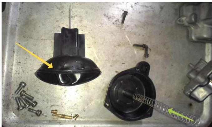
Вакуумный канал место, где скапливается грязь, и все полости очищаем очистителем карбюратора.
