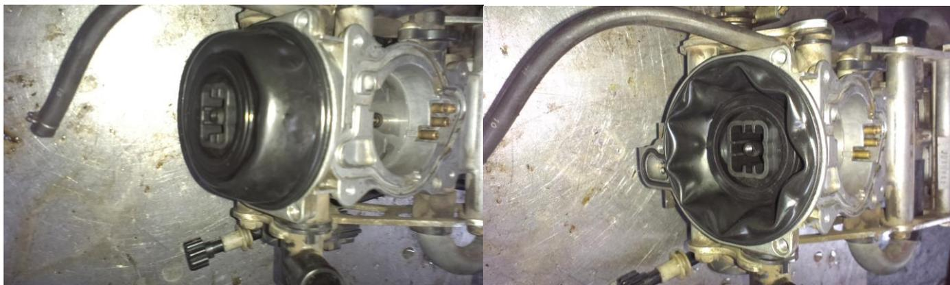
После чистки выполняем синхронизацию, суть синхронизации добиться одинаковых показаний разряжения в обоих цилиндрах. В идеале использовать два вакуумметра, но можно и справиться одним.
