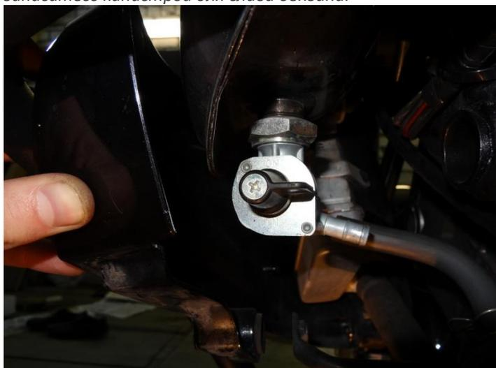
Отвернуть шурупы крестовой отверткой, заменить фильтрующий элемент.
