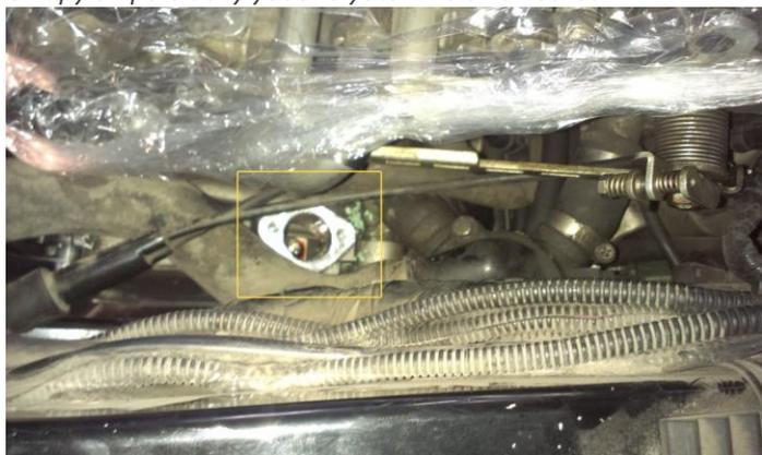
Прикручиваем натяжитель на место, вытаскиваем фиксатор - [желтая стрелка](#), натяжитель должен щелкнуть и натянуть цепь. Старый натяжитель, синяя точка!
