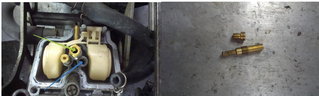
Жиклеры, отворачиваем и заворачиваем их отверткой с правильным шлицом не остро заточенным. Все каналы, полости и жиклеры очищаем очистителем карбюратора.
