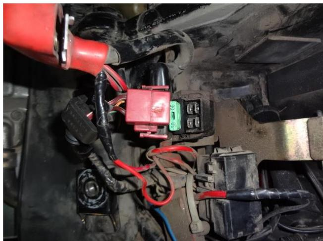
*Тут я решил особо ничего не изобретать, т.к. мои контакты хоть и начали подгорать, но всё же ещё в норме. Я их разгрузил и запараллелил, спаяв между собой. Теперь ток от генератора к потребителям потечёт через спайку, а на заряд АКБ сразу по двум клеммам. Так же и разряд АКБ при не работающем генераторе к потребителям потечёт сразу по двум клеммам.*
