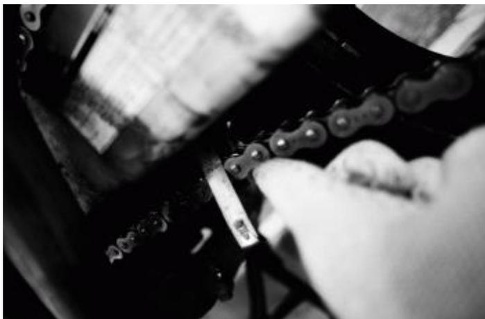
1. Померьте линейкой нижний провис цепи рис. 1, посередине между звездами приподняв ее пальцами. Нормальный провис **35 - 45мм**. Осмотрите всю цепь на предмет износа
