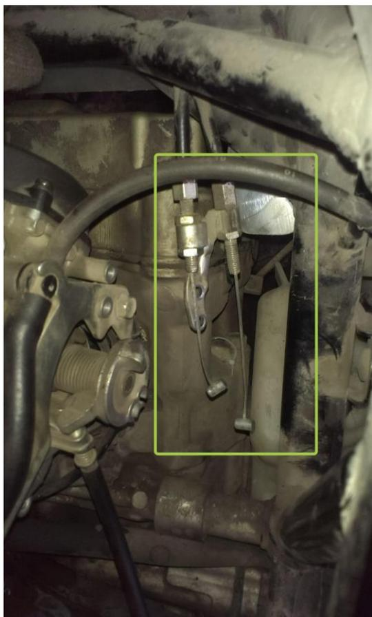
После того как отвернули два хомута крепления, покачиваем и тянем карбюраторы в разные стороны, просто так они не покинут свое место, от стыковываем карбюраторы от manifold.
