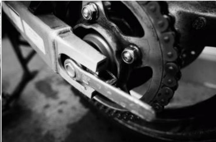
Поворачивайте регуляторы натяжения цепи с обеих сторон маятника таким образом, чтобы заднее колесо на нём сдвигалось назад. Можно делать обороты регуляторов поочередно, чтобы не сбиться, либо выставлять колесо по насечкам, которые можно увидеть сверху на обоих регуляторах. Это важно для регулировки заднего колеса в правильной плоскости. Как правило, если вы регулярно смазываете и натягиваете цепь пол-оборота или целого 360-градусного оборота должно быть достаточно.
