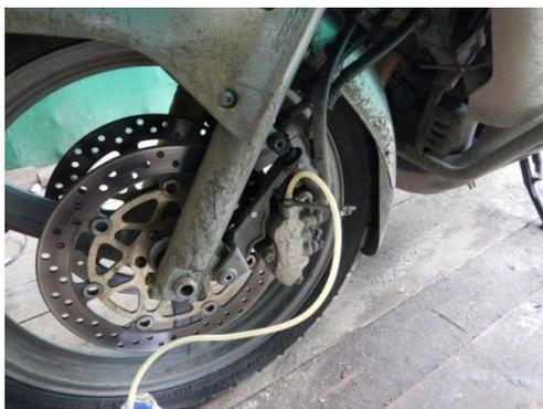
Три-четыре раза нажмите на рычаг тормоза, чтобы создать давление в системе, и держите его в нажатом положении. Немного открутите гайку штуцера, тормозная жидкость начнет выходить через трубку, держите штуцер открытым до тех пор, пока рычаг тормоза почти упрется в руль, в этот момент закройте штуцер, после этого плавно отпустите рычаг.
