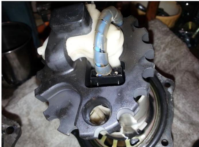
Вытащите пластиковый корпус с насосом, прилагая усилие. Это нормально, т.к. пластиковый корпус вставляется в трубку с уплотнительным кольцом.
