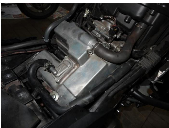
Отсоединив шланги сапуна и PAIR и отвернув четыре болта, снимаем клапанную крышку.
