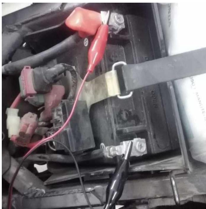
Включаем зажигание (клавиша старт-стоп двигатель на правой ручке должна быть в положении «старт»), лампочка HISS должна гореть. Берем плюсовой крокодил и закорачиваем его на минусовом, на 2-4 секунды (для некоторых мотоциклах достаточно просто отключить крокодил от плюсовой клеммы на 2-4 секунды).
