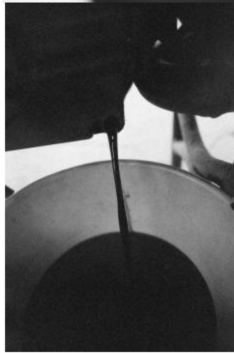
После того, как масло полностью вытекло, вкрутите болт в маслосливное отверстие и затяните с усилием **30\* Нм**.
