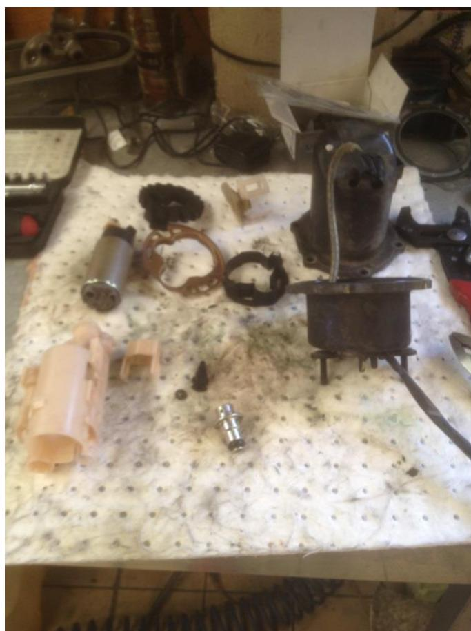
Рис. 9 Общий вид корпуса бензонасоса в разборе
