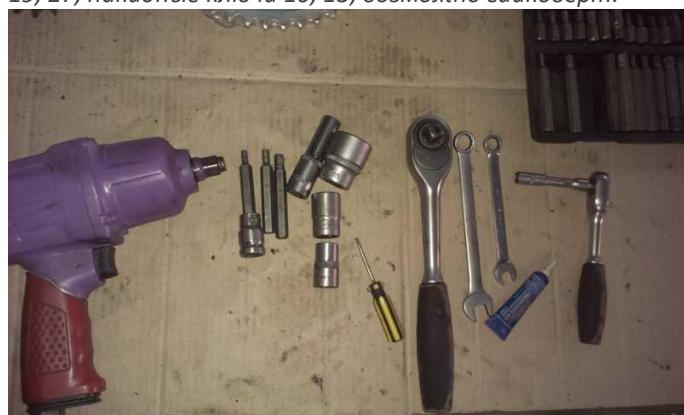
Далее разбираем мотоцикл до вида который на фото, отворачиваем ведущую звёздочку, если нет гайковёрта можно отвернуть воротком необходимо включить первую скорость перед разборкой.
