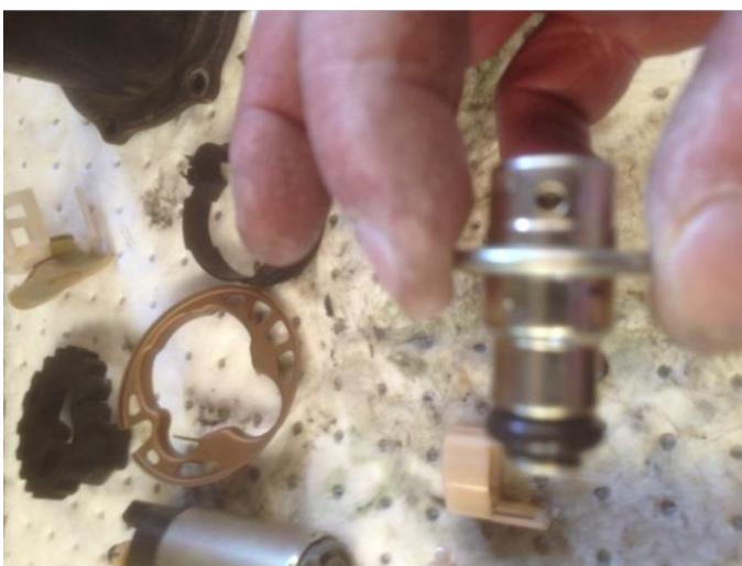
Рис.10 Клапан поддержки давления
