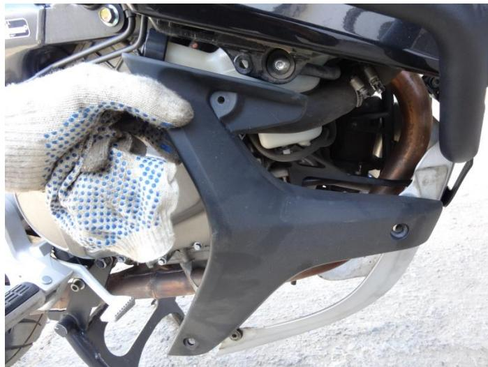
Снимаем пластиковую панель, для доступа к болтам пластика боковины, для других модификаций внешний вид деталей может отличаться.
