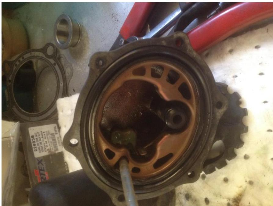
Рис.4 нижняя часть корпуса насос
