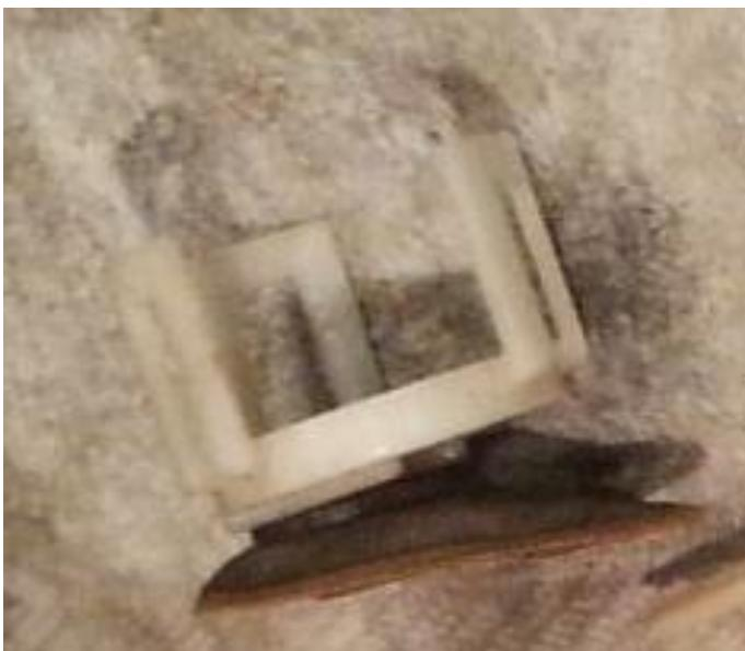
Рис. 6 Пластиковый колпачок с фильтром
