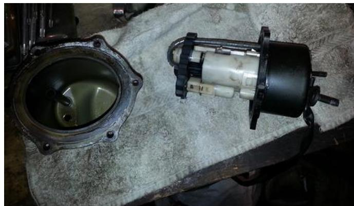
Рис.2. Две половины корпуса бензонасоса
