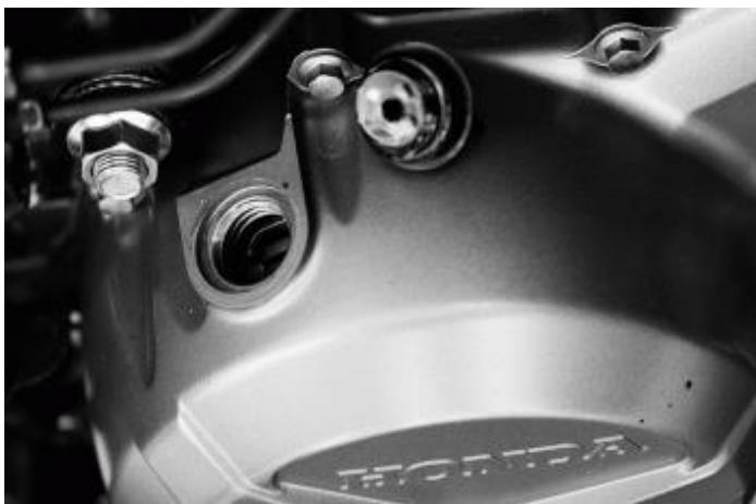
Открутите маслосливной болт в заднем нижнем краю с левой стороны двигателя и дайте маслу стечь в емкость. Проверьте состояние уплотнительной гайки на маслосливном болте на предмет износа и повреждений и замените на новую если понадобится. Желательно вне зависимости от состояния уплотнительной гайки **94109-12000** менять её на новую.
