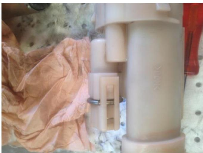
Рис. 8 Крышка клапана поддержки давления
