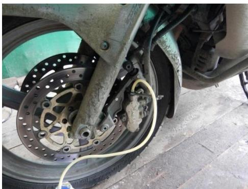
Три-четыре раза нажмите на рычаг тормоза, чтобы создать давление в системе, и держите его в нажатом положении. Немного открутите гайку штуцера, тормозная жидкость начнет выходить через трубку, держите штуцер открытым до тех пор, пока рычаг тормоза почти упрется в руль, в этот момент закройте штуцер, после этого плавно отпустите рычаг.
