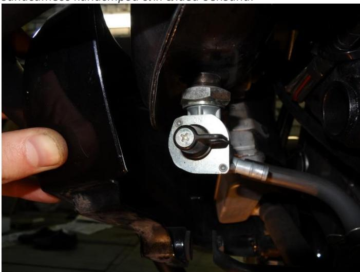
Отвернуть шурупы крестовой отверткой, заменить фильтрующий элемент.
