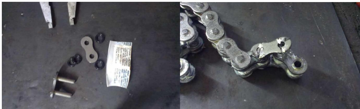
Разворачиваем цепь на столе, собираем замок, не забывая про резинки, смазать оси замка цепи (смазка белого цвета идёт в комплекте с замком)
