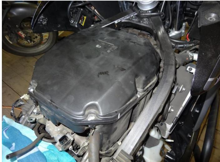
Осмотр полости корпуса воздушного фильтра [карбюраторная модель](#)
