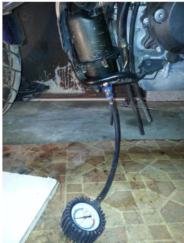
Рис.1 Корпус бензонасоса в сборе
