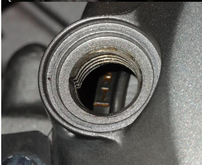
Пред сборкой необходимо смазать поверхности трения распределала и постели, резьбу болтов постели моторным маслом. Постель усаживать плавно, вручную, ни в коем случае не применяя молоток. Постель распределала садится туго, по направляющим. Удары могут перекосить ее и замять направляющие, а так же повредить рабочие поверхности.
