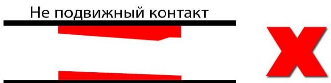
Для выравнивания сильно изношенных контактов, используйте надфиль, если контакты ровные и не изношенные используйте наждачную бумагу 1000 зернистости. **Сильно изношенные контакты необходимо заменить!** Надфиль и наждачную бумагу желательно иметь в наборе инструментов мотоцикла.
