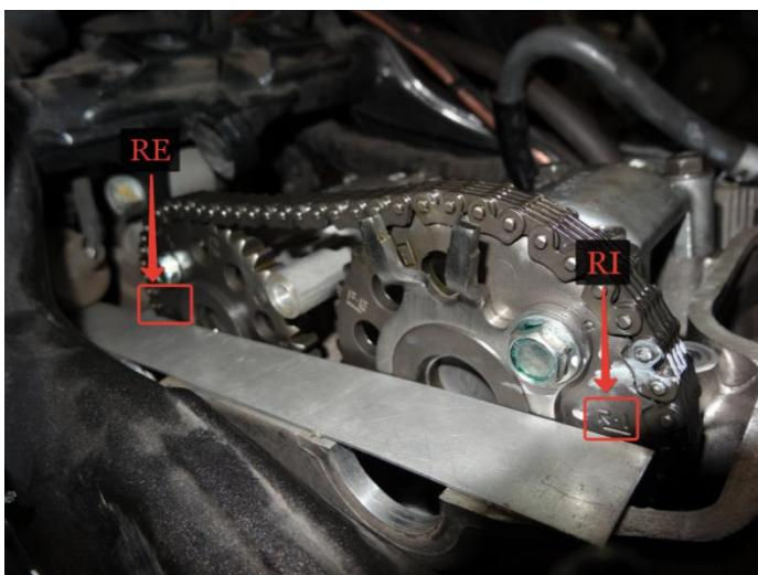
Отвернуть болт заглушки из натяжителя второго цилиндра, вставить Т-образный ключ зелёная стрелка до первого выступа и прокрутить несколько оборотов по часовой стрелке пока усилие пружины будет не преодолимо. Вставить Т-образный ключ глубже при этом нужно попасть в пазы в натяжителе. После этого натяжитель будет ослаблен.
