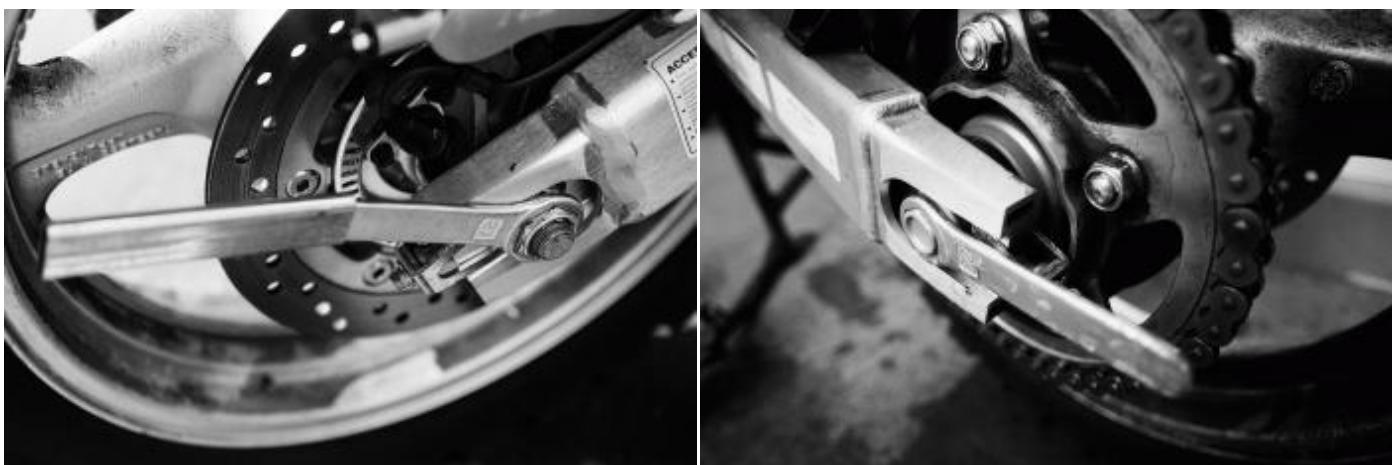
Поворачивайте регуляторы натяжения цепи с обеих сторон маятника таким образом, чтобы заднее колесо на нём сдвигалось назад. Можно делать обороты регуляторов поочередно, чтобы не сбиться, либо выставлять колесо по насечкам, которые можно увидеть сверху на обоих регуляторах. Это важно для регулировки заднего колеса в правильной плоскости. Как правило, если вы регулярно смазываете и натягиваете цепь пол-оборота или целого 360-градусного оборота должно быть достаточно.
