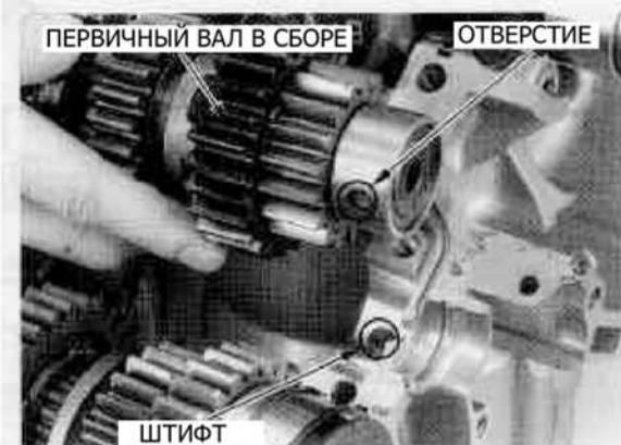
Нанесите фиксатор на резьбу болтов установочной пластины. Поставьте на место установочную (стопорную) пластину меткой «OUT SIDE» наружу, закрутите и аккуратно затяните ее болты.
