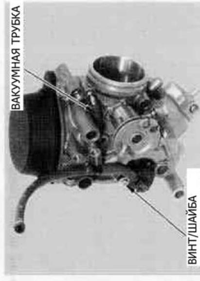
Установите винт и шайбу, затяните винт.
