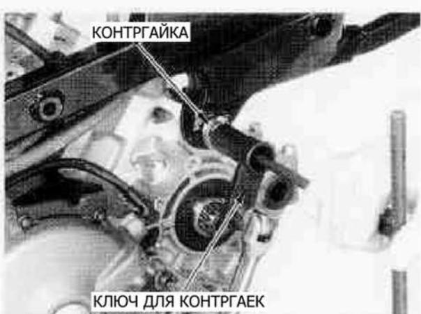
Выньте установочные и подвесные болты, втулки, а затем снимите двигатель из рамы.
