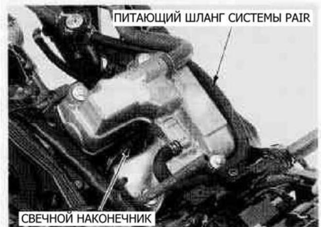
Снимите дренажную и вентиляционную трубы топливного бака с кронштейна на левой стороне двигателя.
