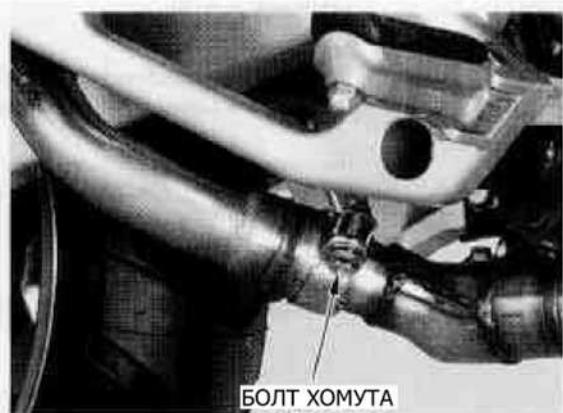
Ослабьте болты хомутов левого глушителя и приемной трубы заднего цилиндра.
